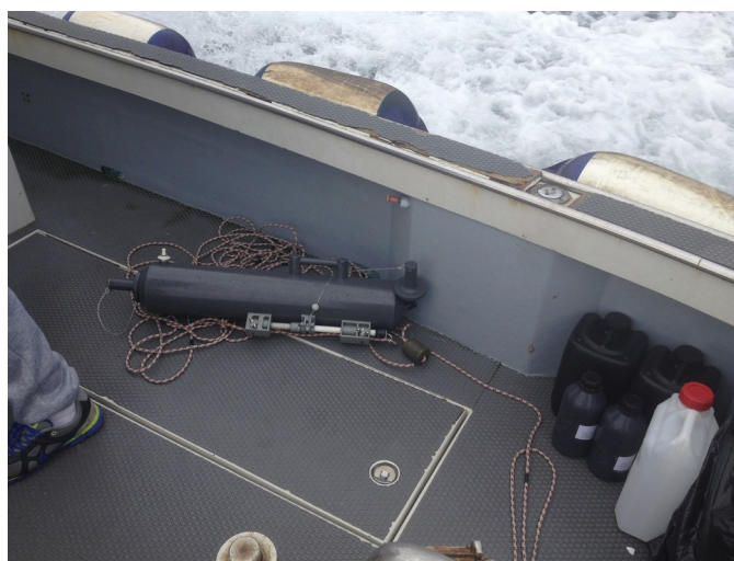
Fig.87 Bottiglia Niskin per il campionamento dell'acqua a differenti profondità
