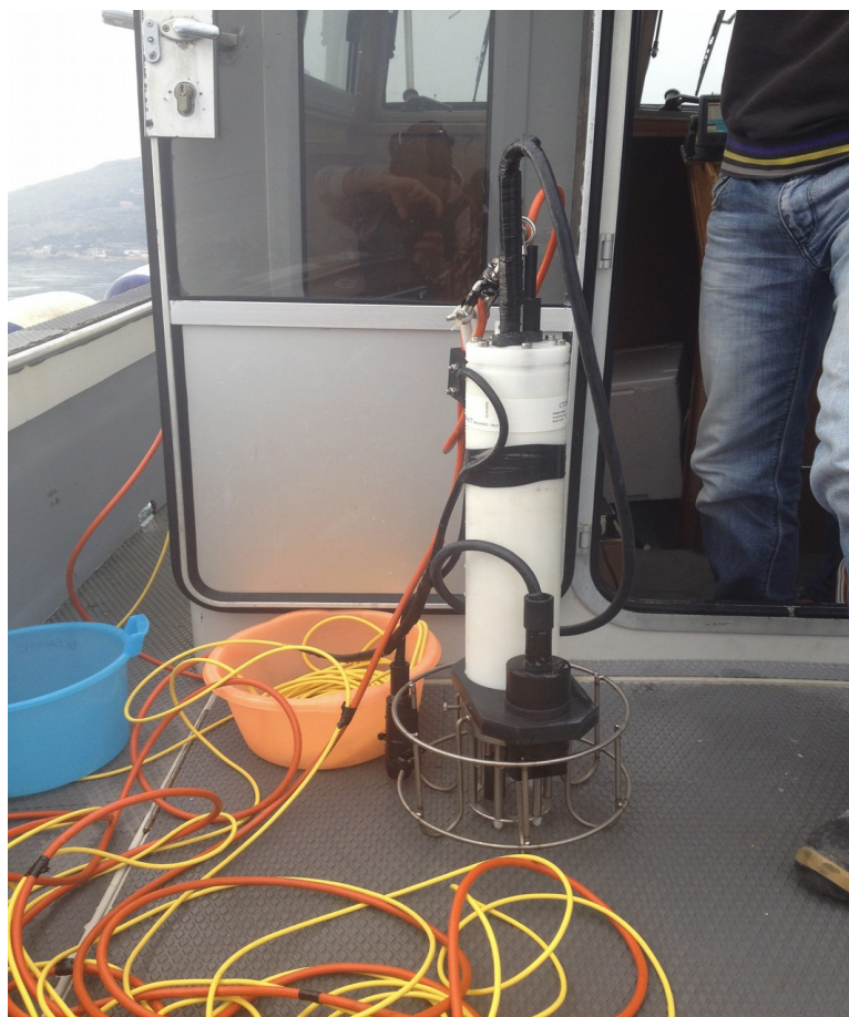
Fig.37 Sonda multiparametrica dotata di sensori per la misura delle principali variabili fisico-chimiche e dei sensori di fluorescenza della clorofilla a e di solido sospeso
